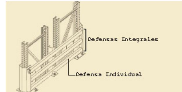
En estanterías se deben disponer de protecciones en las esquinas exteriores o que coincidan con pasillos de tránsito, consistentes en una protección anti-embestidas mínimo de 0,3 m de altura, y que cubra los lados del paral, adicionalmente deben estar pintadas con franjas amarillas y negra. (NTP 298)
