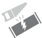
No serruche, lije o corte residuos. Minimice la posibilidad de fractura de productos con asbesto.
