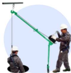
Sistema de montacargas con pértiga
