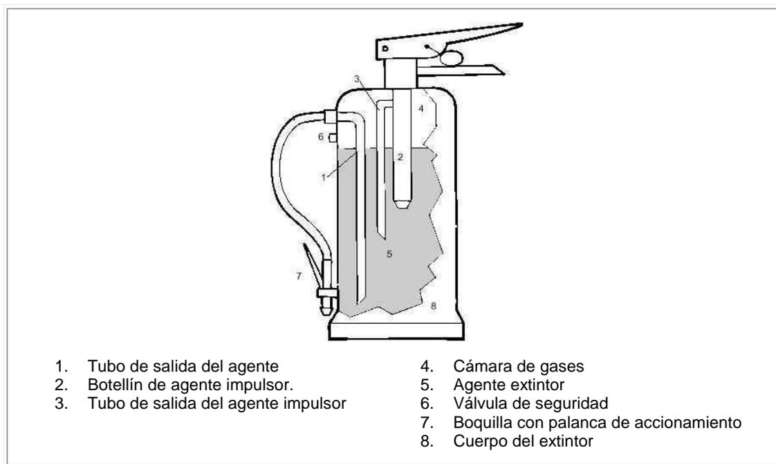
Figura 3. Extintor de incendios de presión no permanente con botellín interior
