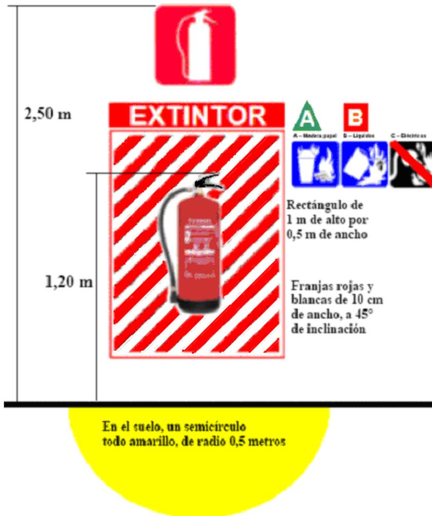
**Figura 1. EJEMPLO DE SEÑALIZACIÓN PARA UBICAR EL EXTINTOR**
