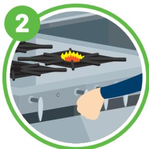
2. Verifique que los quemadores y las rejillas estén ajustadas en el equipo. Gradúe la intensidad de la llama con la perilla.
