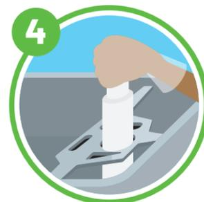
Introduzca la carne con el empujador, nunca con sus manos u otro objeto no diseñado para ese fin (varillas, cuchillos).
