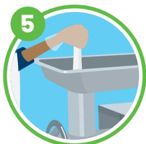
En caso de atasco utilice el empujador, de no ser posible, apague y desconecte el equipo.
