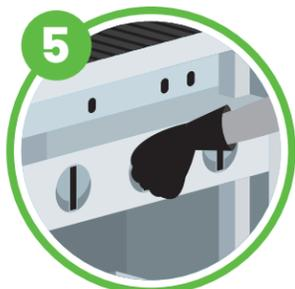
5. Al terminar cierre las perillas y las válvulas de paso del gas. Deje enfriar el equipo en su totalidad e inicie el proceso de desarmado según las instrucciones dadas en el manual de operación del equipo.
