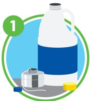
Antes de encender, tenga a mano el mechero industrial y verifique que el combustible no sobrepase los tres centímetros antes del reborde. Humedezca la punta de la mecha.
