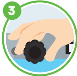
3. Gradúe el espesor de la tajada girando la perilla ubicada al frente de la máquina tajadora.
