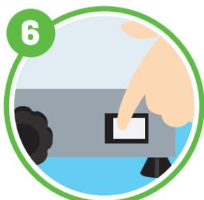
6. Cuando termine de tajar sus productos pare y desconecte la tajadora. Pare la máquina oprimiendo el botón de arranque - parada y desconéctela de la fuente de energía de 120 VAC (tomacorriente).
